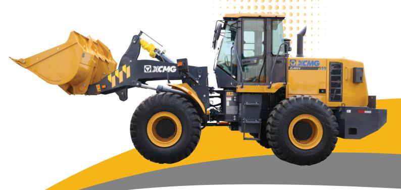
**ENGINE POWER** PAYLOAD CAPACITY - 5000 kg **OPERATING WEIGHT** - 17300 kg BUCKET RANGE
